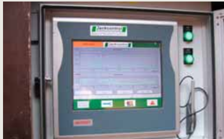
Auf dem Bildschirm kann der Maschinenfahrer alle relevanten Vortriebsparameter in Echtzeit verfolgen. Die Daten werden zusätzlich an die Jackcontrol AG in die Schweiz übertragen.
